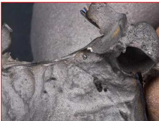
Abb. 1: Lunker im Titanguss
