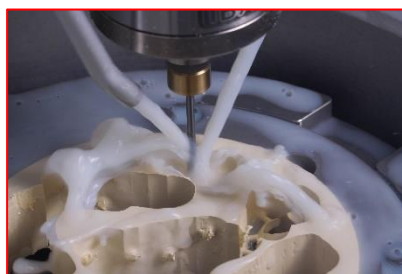
Abb.5: PEEK im Fräsprozess
