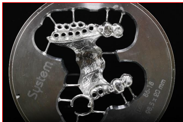
Abb. 2: Titangerüst in der Fräsrunde
